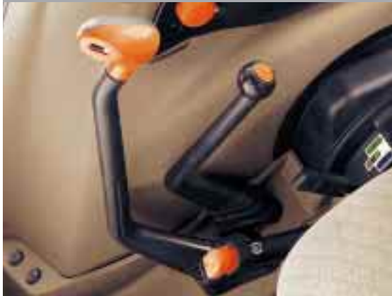
Zweifach-Powershift-Getriebe per Daumendruck zu bedienen.
